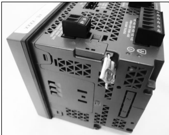
Sealed meter / Compteur scellé
