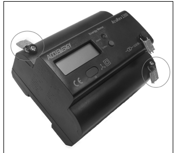
Installation Seals / Sceaux d'installation
