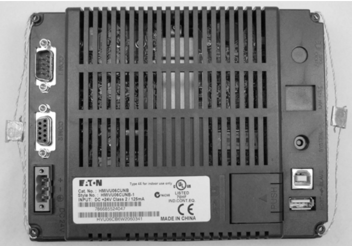
Figure 7: Rear of display with verification seals / Les sceaux de vérification sur l'arrière de l'affichage.
