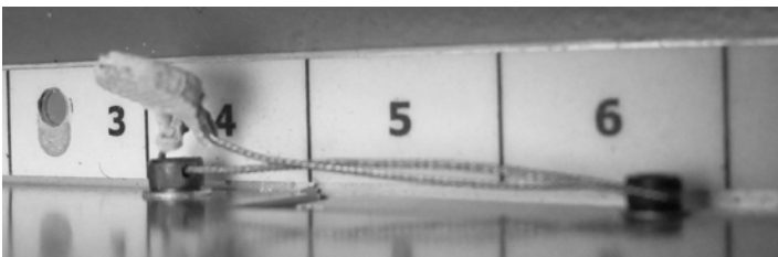
Figure 3: PXMP-SC-S1 verification seal #2 / Deuxième sceau de vérification sur le PXMP-SC-S1.
