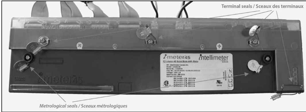
Metrological and terminal seal locations / Emplacements des sceaux métrologiques et des sceaux des terminaux
