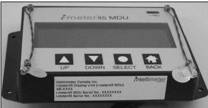
i-meter45 MDU remote display module sealing / Scellage du module d'affichage à distance i-meter45 MDU
