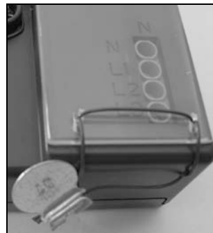
Metrological and terminal seal locations / Emplacements des sceaux métrologiques et des sceaux des terminaux
