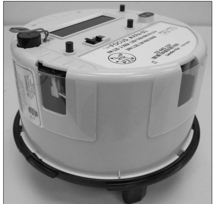
Polycarbonate shields placed over the meter housing access holes / Les boucliers en polycarbonate placés sur les trous d'accès du boîtier du compteur
