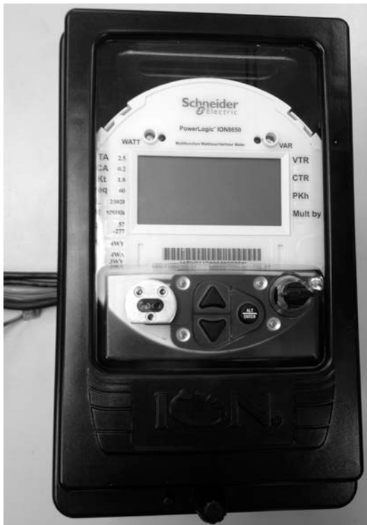
Switchboard type meter. / Compteur pour tableau de distribution.
