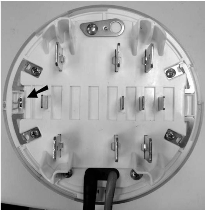
Single seal on a socket type meter / Sceau unique sur un compteur de type socle.
