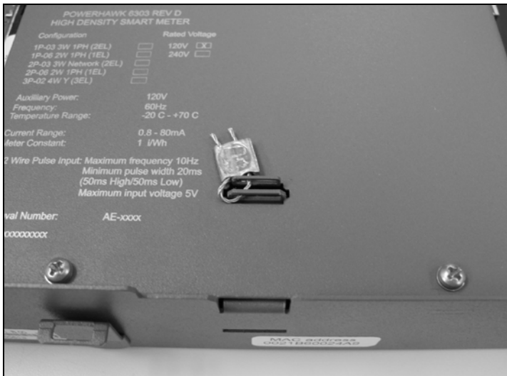
Meter Sealing / Scellage du compteur
