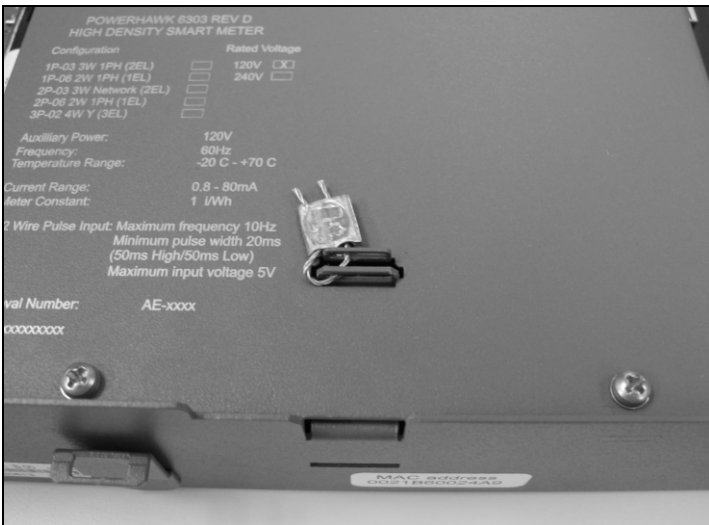
Meter Sealing / Scellage du compteur
