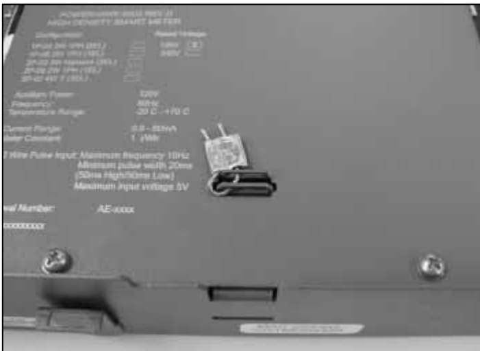
Meter Sealing / Scellage du compteur
