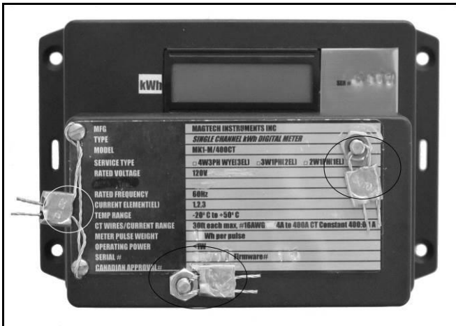
Utility (black circle) and metrology (white circle) seals on terminal cover / Sceaux de service public (cercle noir) et de métrologie (cercle blanc) sur le couvercle des bornes (1)
