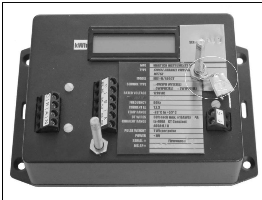
Metrology seals under the terminal cover / Sceau de métrologie sous le couvercle des bornes
