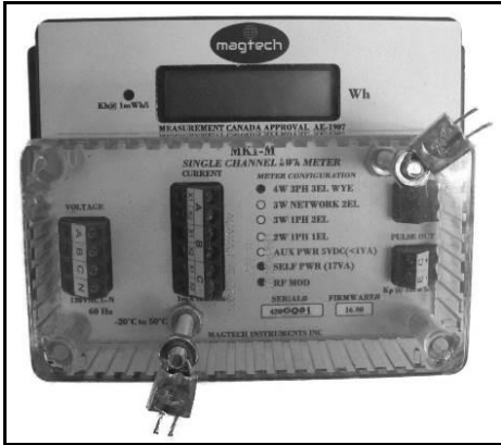
Utility seals for meter with transparent terminal cover / Sceaux de service public pour le compteur avec couvre- bornes transparent
