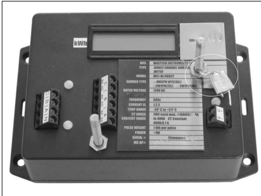
Metrology seals under the terminal cover / Sceau de métrologie sous le couvercle des bornes
