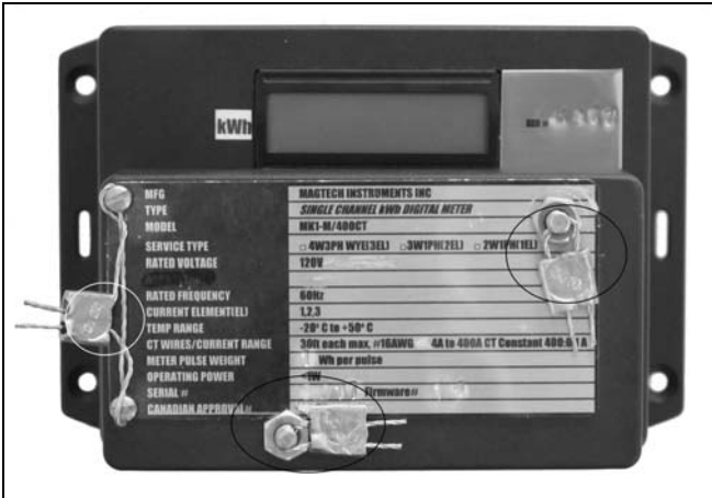
Utility (black circle) and metrology (white circle) seals on terminal cover / Sceaux de service public (cercle noir) et de métrologie (cercle blanc) sur le couvercle des bornes
