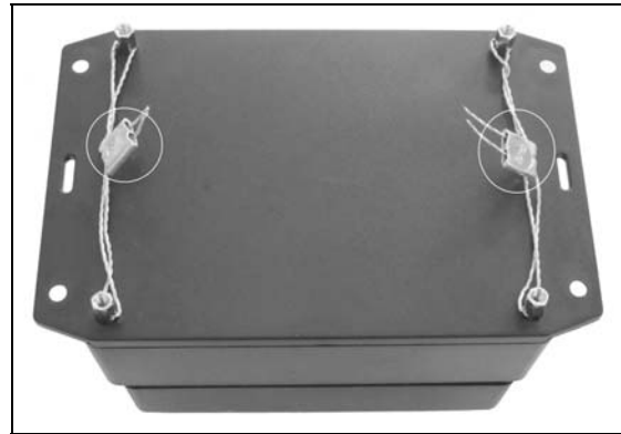
Metrology seals on base / Sceaux de métrologie sur la base du compteur
