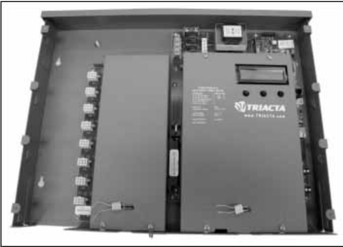
Metrological Sealing Locations / Emplacements des sceaux métrologiques
