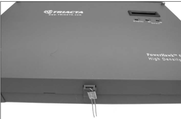
Utility Sealing Location / Emplacement du sceau d'utilité
