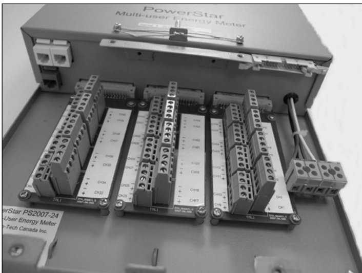
Connections outside of the metrology compartment of PS2007-24 and MR1-1205A-24 / Connexions à l'extérieur du compartiment de métrologie pour PS2007-24 et MR1-1205A-24
