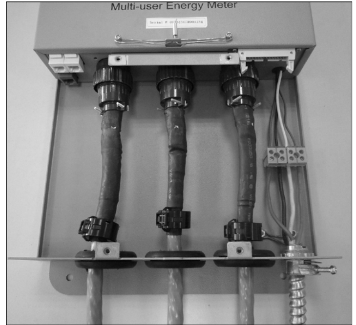
Connections outside of the metrology compartment of PS2007-24A and MR1-120MA-24 / Connexions à l'extérieur du compartiment de métrologie pour PS2007-24A et MR1-120MA-24
