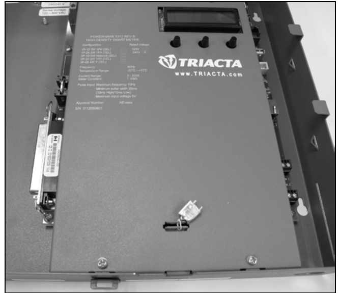
(2) Metrological Sealing Location / (2) Emplacements du sceau métrologique
