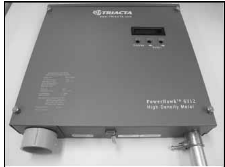
(2) Installation Sealing Location / (2) Emplacement du sceau d'installation
