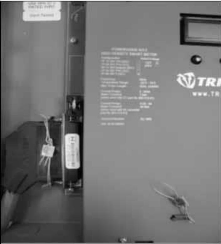
(1) Metrological Sealing Locations / (1) Emplacements des sceaux métrologiques
