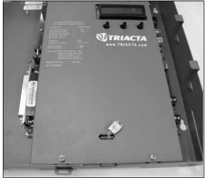
(2) Metrological Sealing Location / (2) Emplacements du sceau métrologique
