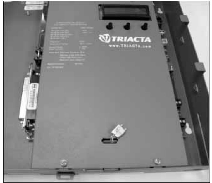
(2) Metrological Sealing Location / (2) Emplacements du sceau métrologique
