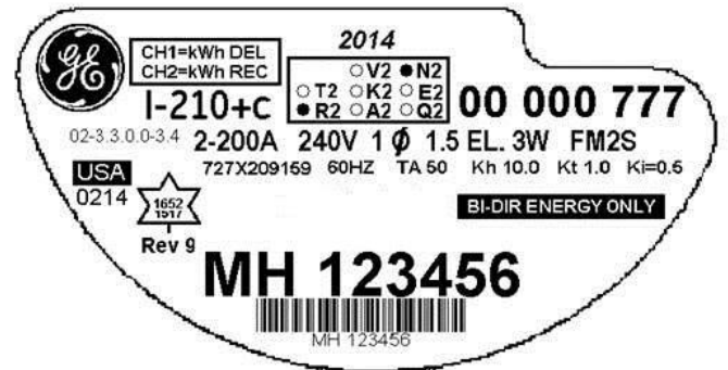
Updated nameplate with both the Application FW and Metrology FW identified (3.3.0.0 & 3.4) / La nouvelle plaque signalétique avec les micrologiciels d'application et de metrologie identifiés (3.3.0.0 & 3.4)
