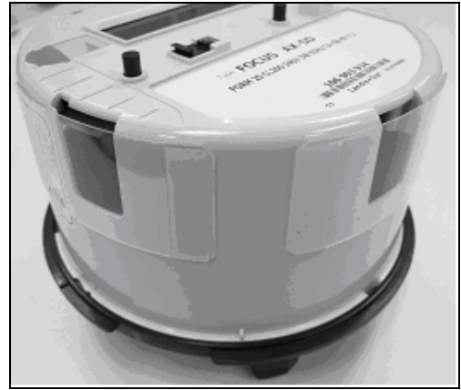
Polycarbonate shields placed over the three meter housing access holes / Les boucliers en polycarbonate placés sur les trois trous d'accès du boîtier du compteur
