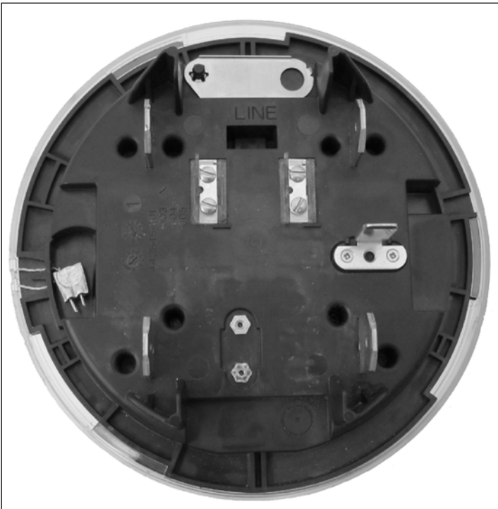
Sealed CENTRON II OpenWay shown with revised plugs equipped with test links / CENTRON II OpenWay scellé, montré avec les bouchons révisés qui sont équipés de barrettes conducteurs d'essai
