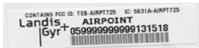
Rev.4: Focus II with Integrated HP AirPoint (Note: Presence of Landis+Gyr marking on label) Rév. 4: Focus II avec HP AirPoint (Note: Présence du titre Landis+Gyr sur l'étiquette)
