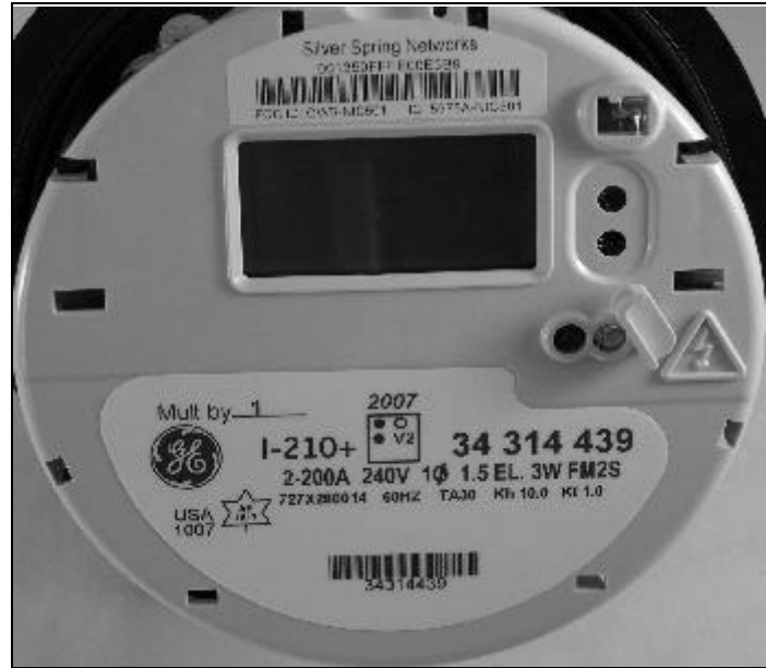
I-210+ with Silver Spring Networks I-210+ avec module Silver Spring Networks
