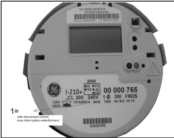
I210+ with disconnect switch / I210+ avec l'interrupteur- sélectionneur
