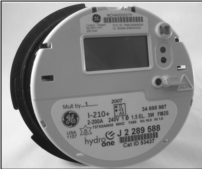
I-210+ with Trilliant SecureMesh NCZR111PH-I210 module I-210+ avec module NCZR111PH-I210 de Trilliant
