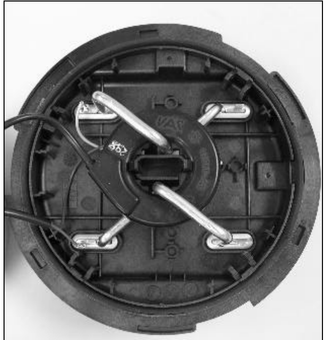
New current transformer and terminals / Nouveau transformateur et terminales
