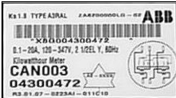
Original nameplate of Alpha 3 meters / Première plaque signalétique des compteurs Alpha 3
