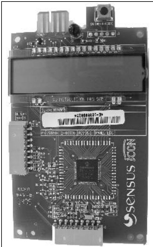
Rev 3 meter / Compteur rév. 3 Display board (front) / Carte d'affichage (face)
