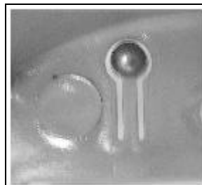
Meter reset switch pushbutton (original) / Poussoir de remise à zéro du compteur (d'origine)
