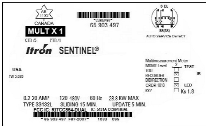
Nameplate with Trilliant Networks CRDR-1010 module / Plaque signalétique avec le module Trilliant Networks CRDR-1010
