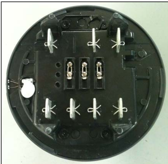
Sealed Socket Type Meter / Le compteur de type de socle scellé
