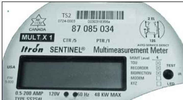
Nameplate with 0726 TS2 module / Plaque signalétique avec le module 0724 TS2
