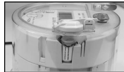
Battery Hatch / La trappe de la pile
