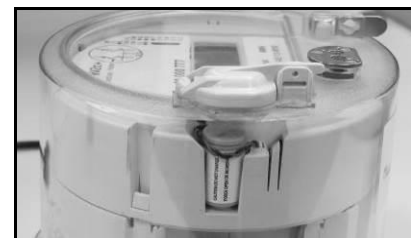
Battery Hatch / La trappe de la pile
