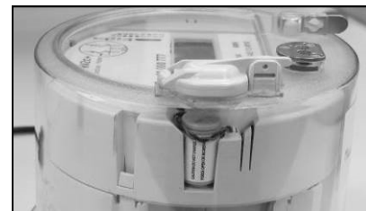
Battery Hatch / La trappe de la pile
