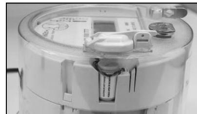
**Battery Hatch / La trappe de la pile**
