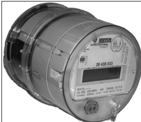
KV2c retrofitted with Tantalus PP-1310 / KV2c avec le lecteur automatisé de compteur Tantalus PP-1310
