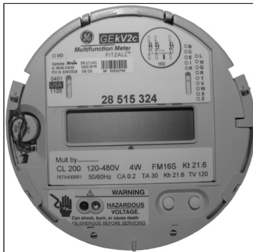
KV2c retrofitted with 53ESS Itron module / KV2c avec le module 53ESS d'Itron
