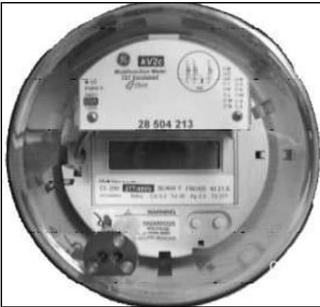
kV2c with external Turtle TS1 pulse counting AMR / kV2c avec lecteur automatisé de compteur externe Turtle TS1
