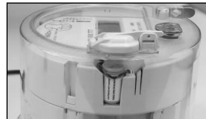
Battery Hatch / La trappe de la pile
