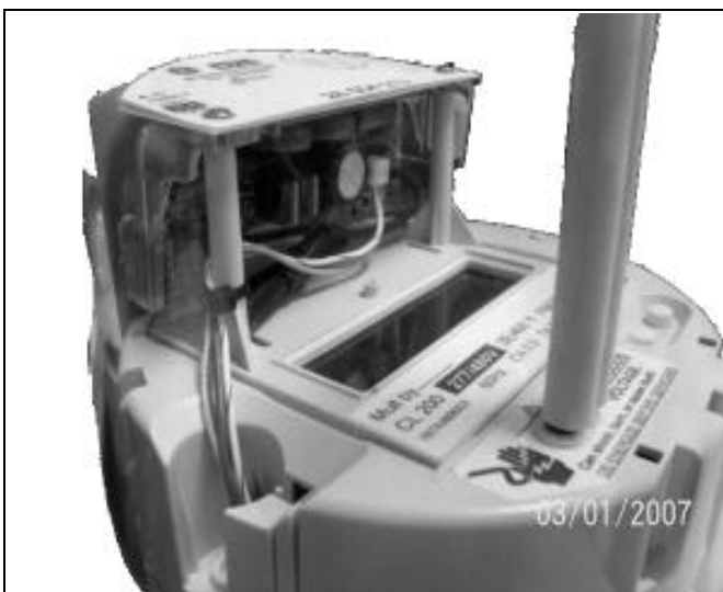
External TS1 Pulse Counting AMR Module/Module de lecture automatisée de compteur externe à compte d'impulsions TS1
