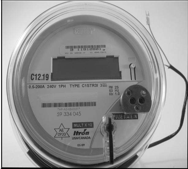
**C1STR3I with Pulse/State Input Board / C1STR3I avec le module Pulse/State Input**
