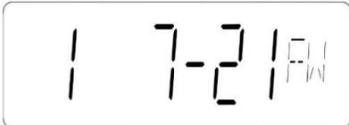
Example of firmware version 7.21 | Exemple de la version 7.21 du logiciel
