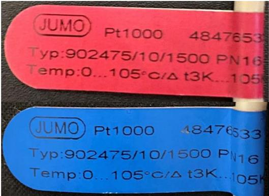
Paired Temperature Sensors | paire de sondes de température
