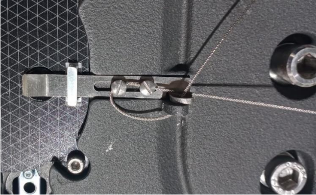
Figure 7 Sealing step 1 of 2: after tightening screws | Etape de scellage 1 sur 2 : après le serrage des vis
