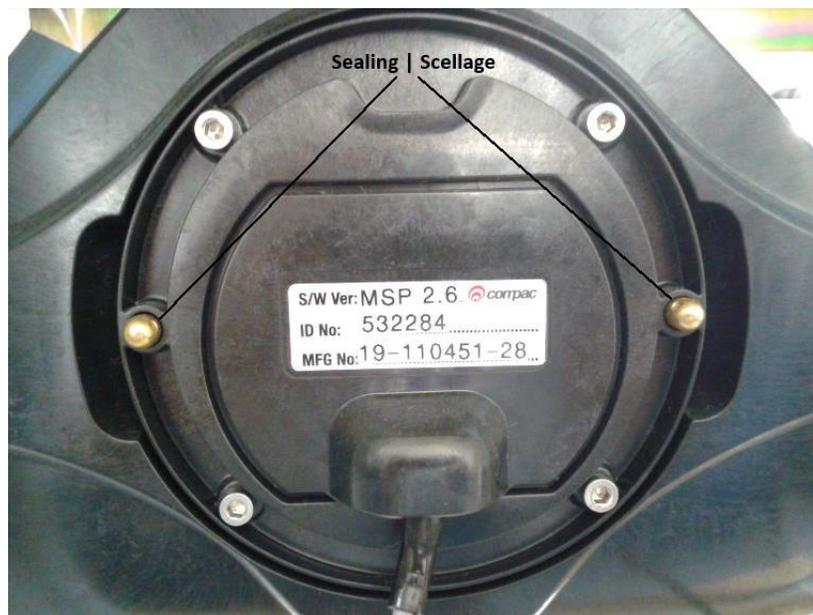
Figure 6 Sealing points on Coriolis meter transmitter | Les points de scellage sur le transmetteur du compteur Coriolis
