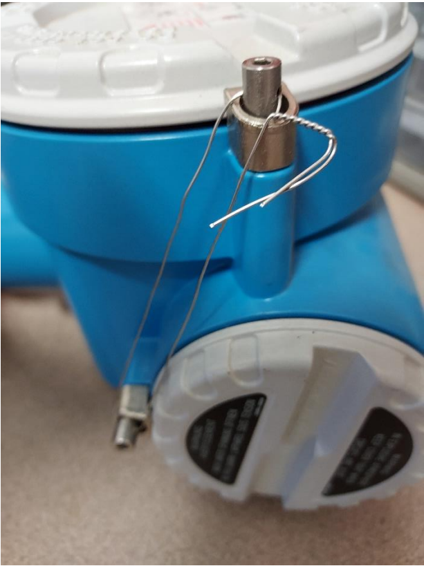
Figure 4: LPGmass 8FE15 Transmitter sealing Scellage du compteur pour l'émetteur LPGmass 8FE15
