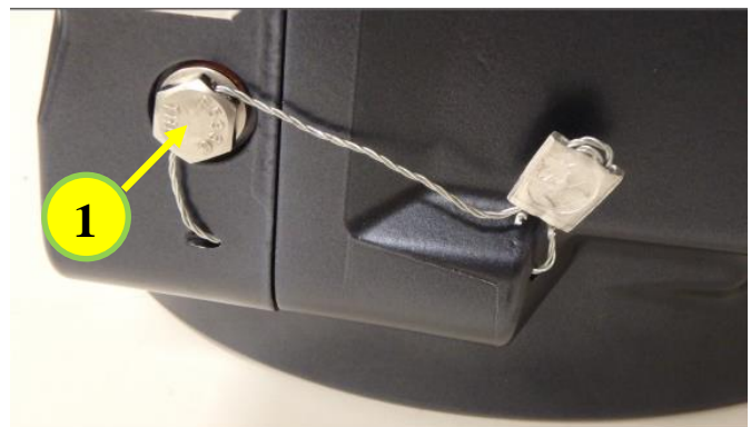
Figure 3 The seal on the calibration bolt '1' | Le sceau sur le boulon d'étalonnage '1'
