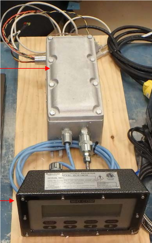
Fig. 3 : E:Count LTIS Register and Intrinsically Safe Power Control Module (PCM) / Enregistreur E:Count LTIS avec le module de contrôle d'alimentation à sécurité intrinsèque (MCA)
