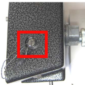
Fig. 1: E:Count LTIS Register sealing / Le scellage de l'enregistreur E:Count LTIS
