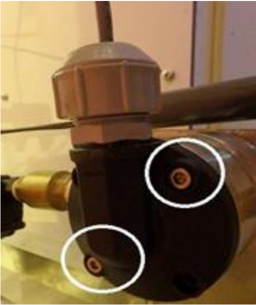
Figure 6: Paper seal on meter cover | Sceau de papier sur le couvercle du compteur
