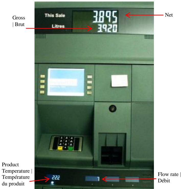
Figure 3 Display of Gross/Net volumes, temperature, and flow rate in inspection mode | Affichage des volumes brut et net, de la température, et le débit en mode inspection
