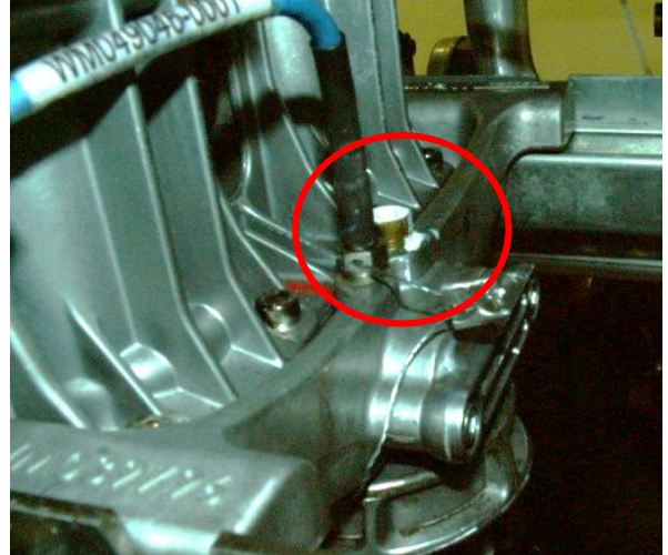
Figure 12: Side of Xflo meter with the ATC temperature probe and thermowell / Vue latérale du Xflo avec la sonde du CAT et le puit thermométrique
