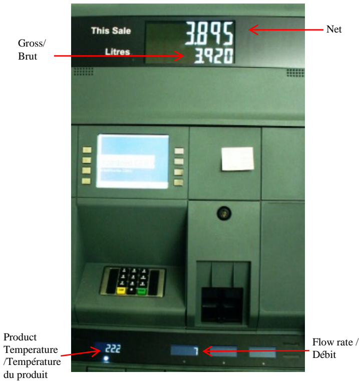
Figure 3: Display of Gross/Net, temperature and flow rate during inspection mode / Affichage du brut et net, de la température et le débit en mode inspection
