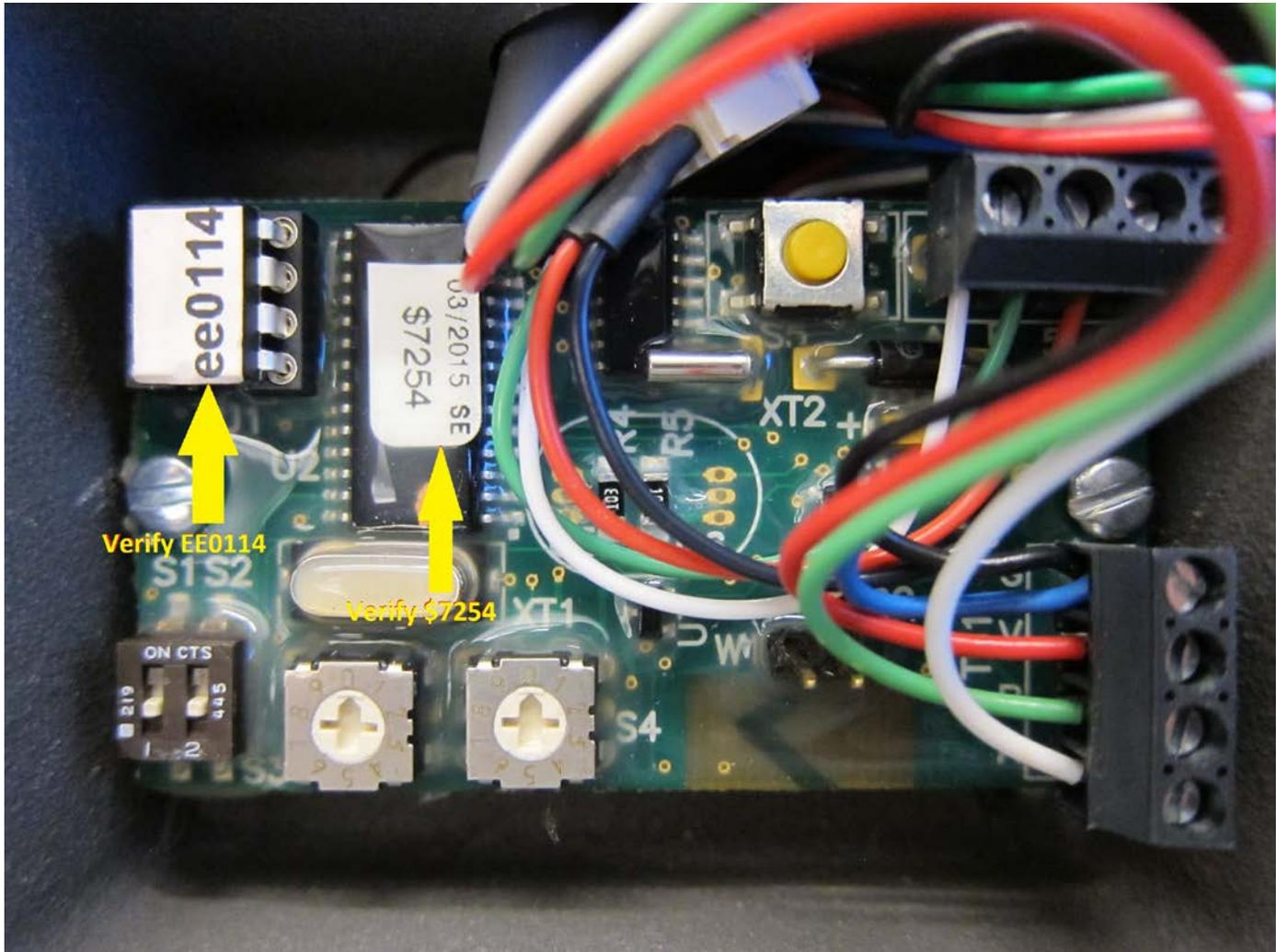
**Image 1** : CSL board firmware and EE Prom numbers confirming that no linearization is possible with the board / Numéros de micrologiciel et EE Prom confirmant que la linéarisation n'est pas possible avec la carte SCL.
